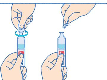
図のように薬液が入っていない部分を持ち、容器の先端をねじって、取り外してください。
